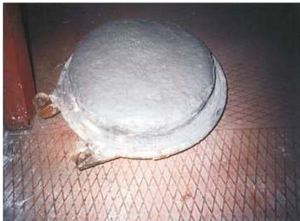
Применение материалов ВБФ для футеровки заслонок тепловых агрегатов
